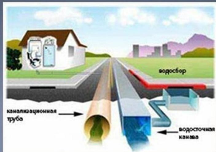
Схема раздельной централизованной системы водоотведения населенного пункта.
