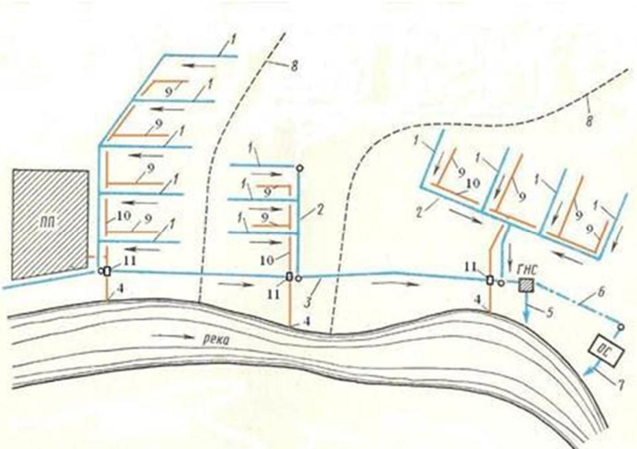
Схема совмещенной централизованной системы водоотведения населенного пункта.
